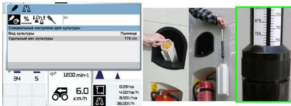
Рис.2 - Определение насыпной плотности убираемой культуры на примере зерноуборочного комбайна CLAAS
