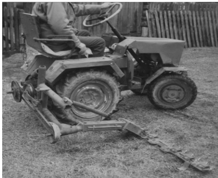
Рис. 1 - Мини-трактор с косилкой
