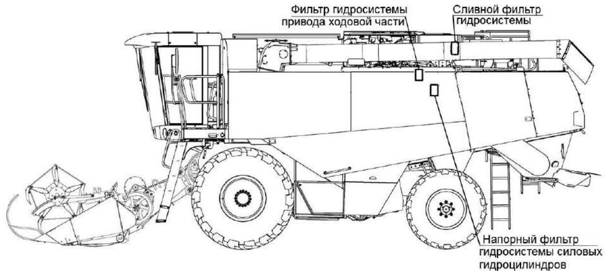
Рисунок 1.22 – Схема размещения фильтров гидросистемы комбайна
