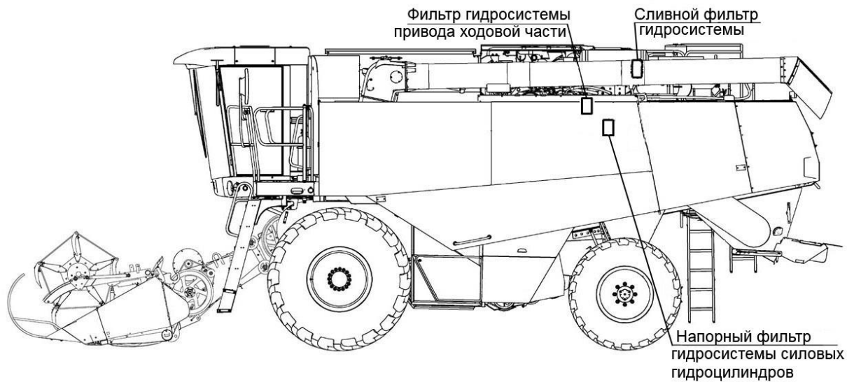
Рисунок 1.22 – Схема размещения фильтров гидросистемы комбайна
