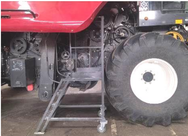
Рисунок 3.7 – Лестница с площадкой для заправки насоса АЦСС
