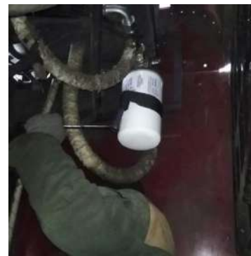
Рисунок 3.13 – Сливной фильтроэлемент, демонтируемый при помощи ключа фильтра
