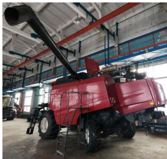
Рисунок 3.13 – Вид на трубу выгрузного шнека повернутую на угол не менее 50°
