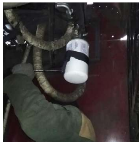
Рисунок 3.11 – Сливной фильтроэлемент, демонтируемый при помощи ключа фильтра
