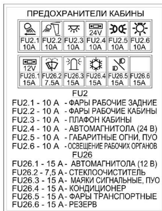
Рисунок 1.37 – Схема расположения предохранителей
